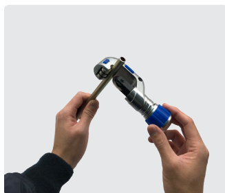
パイプをカット
