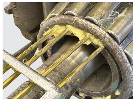
●専用爪が隙間に入ります (4本爪をローラーとローラーの間に 端から入れていって下さい。)
