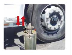
③ K1800DS2 のハンドポンプ Assy のハンドルを上下に動かし、ポンピングを行ってください。本体タンク内に圧力が掛かってきて軽油が6R10 のフィルターケースに注入されます。
