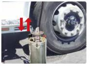
④エアーを K1800DS2 に注入すると軽油が 6R10 の燃料フィルターケースに注入されていきます。
