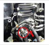
②ハンドポンプ Assy をしっかりセットして、 K1800DS2 のホースの接続カプラを 6R10 エンジンの燃料フィルターケースの接続口に接続します。
