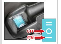
本体 (フタ) にあるスイッチを供給 (ー) 側に押すと、 新しいフルードが供給されます。 フルードが供給されるときにモーター音が聞こえ、 スイッチ LED が点灯します。
