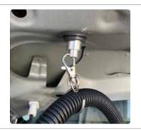
マグネットを車両の金属部分に固定してください。 固定する際に、先端のセンサー部がフルードタンクの位置になるように 調整してください。
