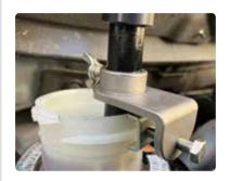
リザーバータンクからブレーキフルードが溢れない適度な 液面レベルで供給が停止されることを必ず確認してください。
