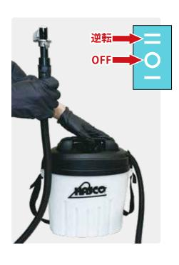
作業終了後、リザーバーの液面レベルが MAX レベルを超えている場合、スイッチの逆転 (=)を押して超えている分を吸引してください。
