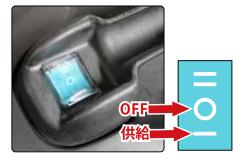
供給・逆転を切り替えた際に、起動前にスイッチ LED が点灯します。 点滅回数によって電池の残量が分かるようになっておりますので、 以下の点検を行ってから作業にあたってください。
