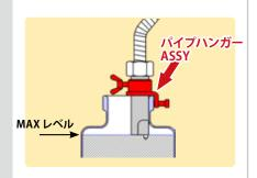
センサーの先端部を液面の MAX 付近に合わせ、 パイプハンガー ASSY で軽く固定します。
