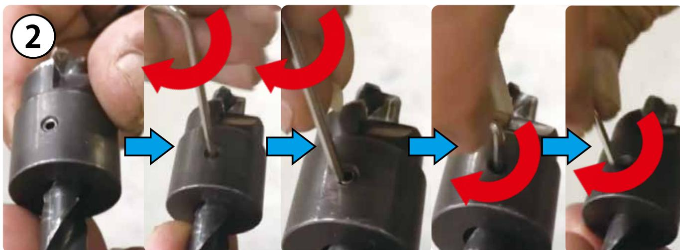
②作業するアルミ縞板が貫通出来る位にアタッチメントからドリル先端部を出して、付属六角レンチでアタッチメント 2 箇所のイモネジを確実に締付セット完了です。
