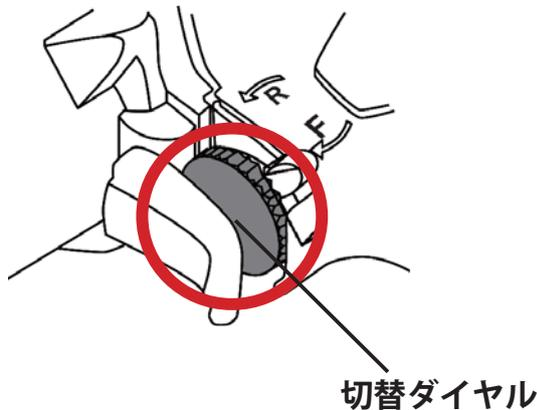
出力切替ダイヤルを回すと、出力を切り替え可能
