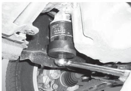
**逆ネジスクリュータイプの刃が強固に喰いつく！頑固な固着も剥がして取り外しができます！**
