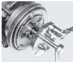
センタータップタイプの抜き取り 3本タップ式クラッチの抜き取り
