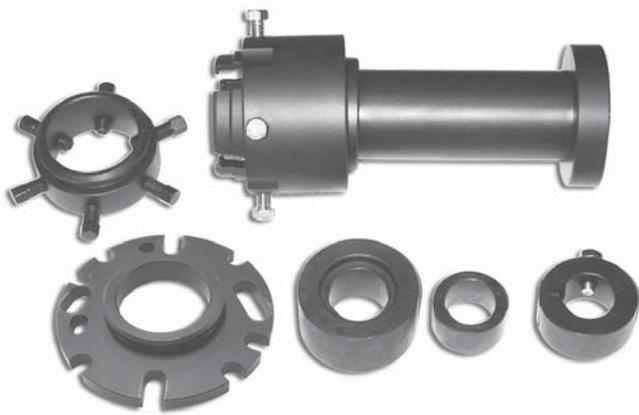
**硬くて抜けにくいリテーナーをタガネ、酸素など使用せずに油圧プレスで抜き取り!**
