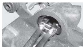
ダストブーツ溝用ブレードは硬質材。サビもガリガリ落とせます。
