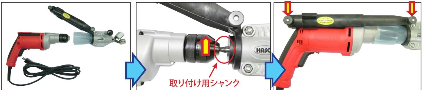
ツール本体の取り付け用シャンクにドリルのチャックを接続し、
