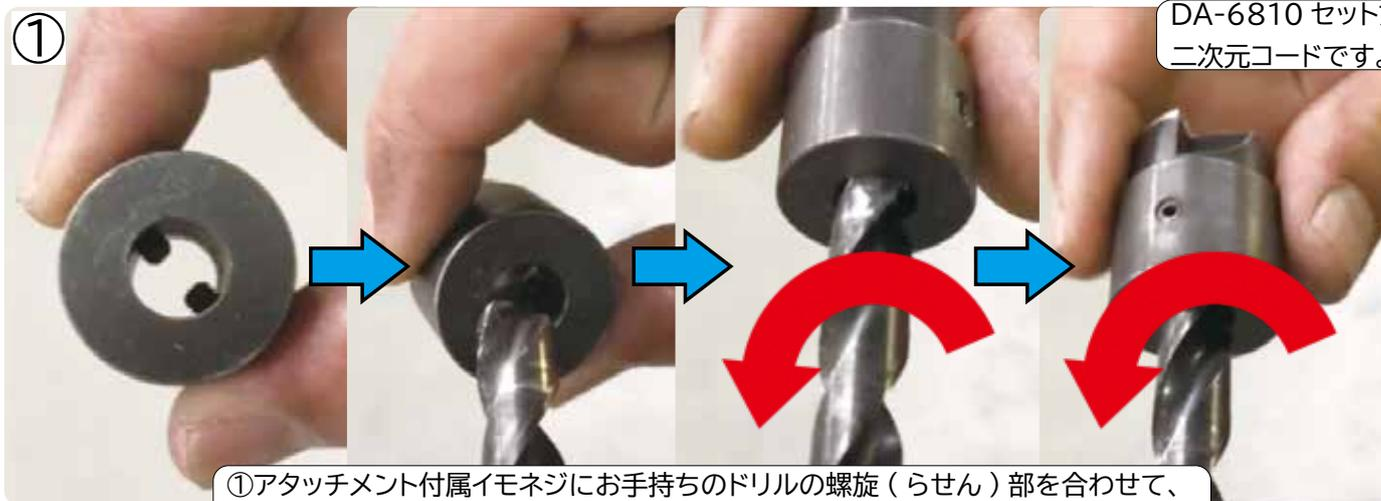
①アタッチメント付属イモネジにお手持ちのドリルの螺旋（らせん）部を合わせて、アタッチメントをドリルの螺旋（らせん）部にそって回しながらセットして行きます。
