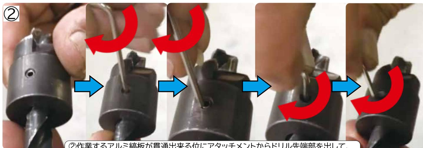
②作業するアルミ縞板が貫通出来る位にアタッチメントからドリル先端部を出して、付属六角レンチでアタッチメント 2 箇所のイモネジを確実に締め付け完了です。
