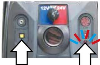
⑥ 電圧表示ボタン ④ 電圧表示 LED
