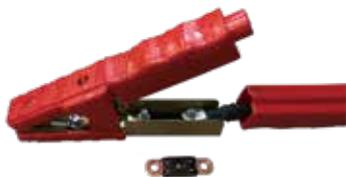
④ヒューズを取外し、新しいヒューズを組替え、逆の手順で組み直してください。
