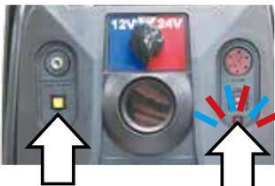
⑥ 電圧表示ボタン ④ 電圧表示 LED
