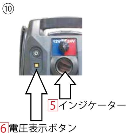
⑩ 約 5 分後 **6 電圧表示ボタン** を長押し、**5 インジケーター** で 12V の場合 14.0V、24V の場合 28.0V 付近まで充電されていることを必ず確認してください。
