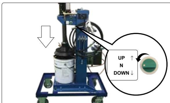
上昇 / 下降スイッチを "N" に切り替えてください。ゴム蓋部分が下降します。
