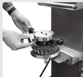
図の向きにベアリングをセットし
