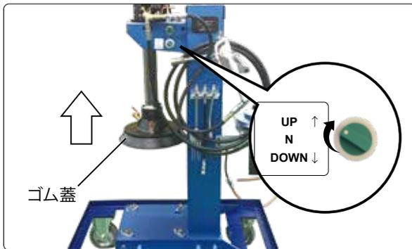
上昇 / 下降スイッチを "UP" に切り替えてください。ゴム蓋部分が上昇します。
