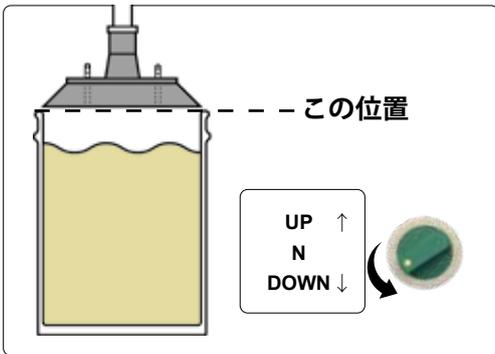
グリス缶にゴム蓋が接触したら、スイッチを“DOWN”位置に切り替えて下さい。
