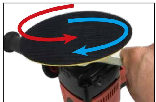
取り付ける時のベースパッドを回す方向 (時計回り)
