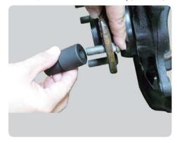
ハブのセレーションと新品ハブボルトの セレーションを合わせてハブにセット後 アタッチメントをセットします。
