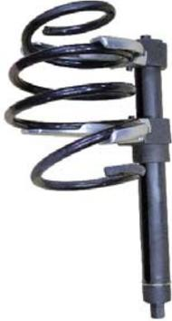
圧縮されたスプリングを外し、保護スリーブ、ダンパーを抜き取り交換します。
