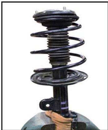
マクファーソンストラットを車輛から外し、バイスにクランプする。
