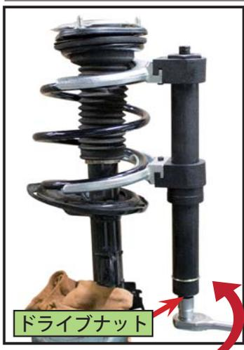
本体をスプリングに取り付け、**ドライブナット**を締め込み圧縮する。
