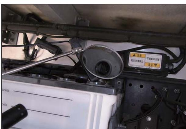
各セル給水口に補水が完了しているか
