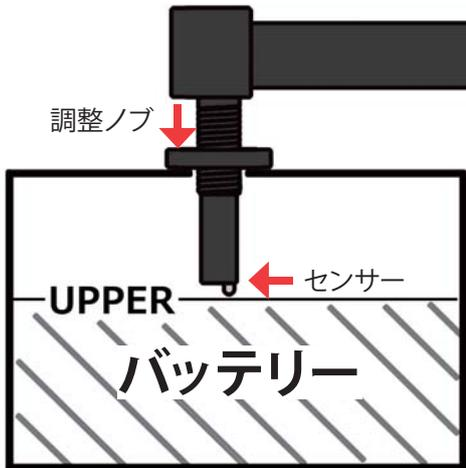
補水するバッテリーのアップーレベルにノズル先端（センサー）が触れるよう、ノズル位置の調整を行います。
