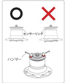
センサーリング・工具(キャップ)がハブに対して斜めになってしまった場合は、 水平になる様に工具(キャップ)をセットし直してください。
