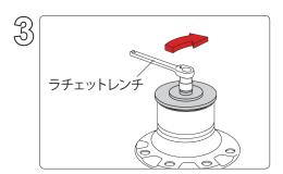
アタッチメントがしっかりとセンサーリングに当たっているのを確認後、ラチェットレンチでセンターボルトを締めて圧入してください。
