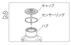
ハブ表面に左図の要領で センサーリングをセットします。 センターボルトを回転止めに軽くねじ込んでください。
