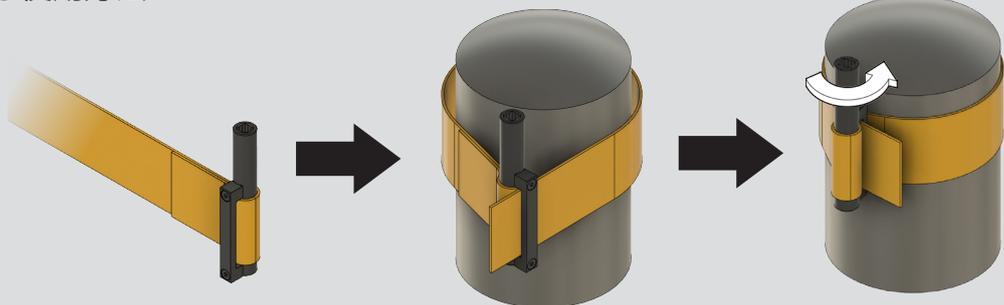
フィルターに巻きつけて回します。逆方向に回す際は、逆方向に巻きつけて下さい。
