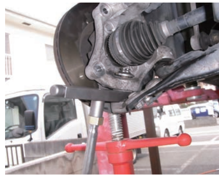
狭い隙間に打ち込み
