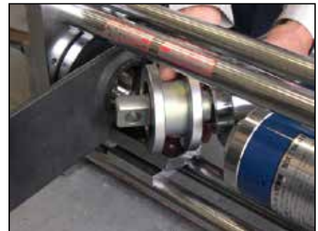
15, 圧縮したブッシュに、ブッシュアタッチメント(向きに注意: 矢印方向がブッシュ)、カラーを通してセットします。
