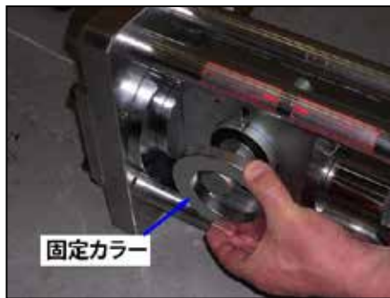
11, 固定カラーを、左右両側に嵌め込み、ブッシュの開きをロックします。
