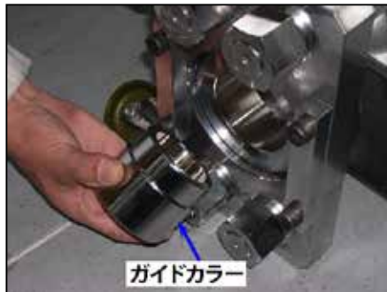
14, フロントプレート外側から、ガイドカラーを径の細い方から入れ、ブッシュ装着部に嵌め込みます。この作業を怠ると、センターがずれて無理が掛かり、ブッシュおよび本ツールが破損します。
