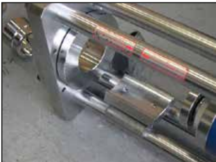
13, 当て金(大)を外し、ベースB(真上からの作業時はベースA)には受け台をセットします。
