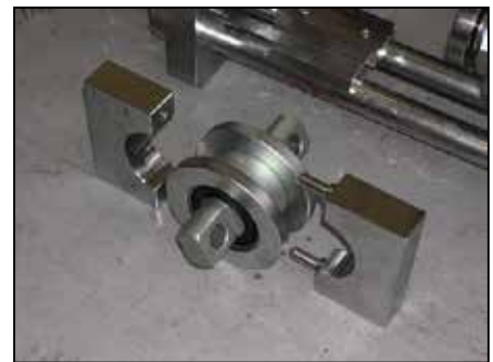
12, いったん油圧を抜き、ブッシュコンプレッサーから圧縮されたブッシュを取り出します。
