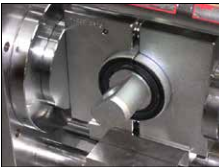
10, ブッシュコンプレッサーがロックする位置まで圧縮します。この時の圧力は約5トン程度です。
