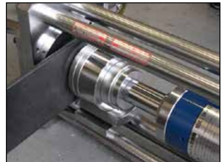
18, 固定カラー、カラー、当て金が密着したら装着完了です。この時の圧力は、高くても10トン以下です ※絶対に、それ以上無理に圧縮はしないでください。
