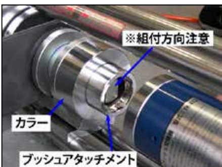
16, ブッシュ取付金具の向きを、整備要領書通り正確にセットします。
