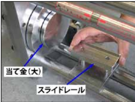
7, いったんスタビリンカーを枠外に外し、ガイドに当て金(大)を、ベースB(真上からの作業時はベースA)にはスライドレールをセットします。
