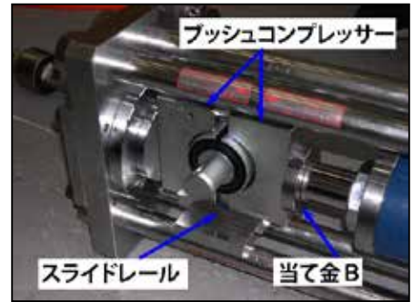
9, スライドレール上に、ブッシュを挟んだブッシュコンプレッサーを、写真のような向きでセットします。本体には、当て金Bをセットしたまま、油圧ポンプを作動させて、ブッシュを圧縮します。
