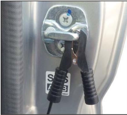
1. 本製品のワニグチを車体のバッテリーの⊖またはボディアース(金属部分)へ接続します。
