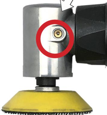
ギアの焼き付き防止の為、時々モリブデン系グリスを左の写真の注油ニップルへ市販のグリスガン及びグリスニップル用ノズルを使用して注入してください。ギアの寿命が延びます。
