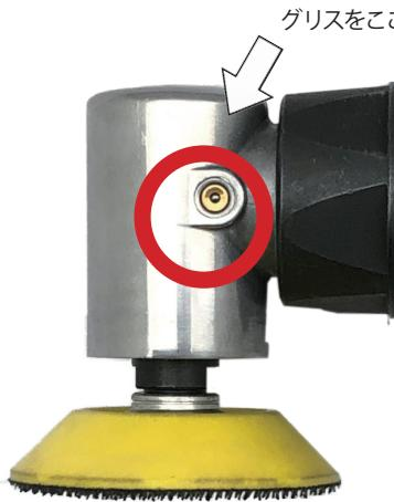
ギアの焼き付き防止の為、時々モリブデン系グリスを左の写真の注油ニップルへ市販のグリスガン及びグリスニップル用ノズルを使用して注入してください。ギアの寿命が伸びます。
