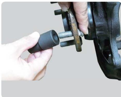
ハブのセレーションと新品ハブボルトのセレーションを合わせてハブにセット後アタッチメントをセットします。
