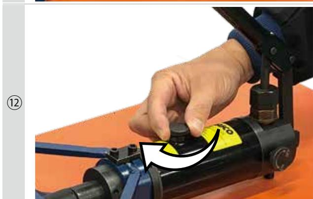
⑫使用後は必ず給油キャップを閉めて下さい。
