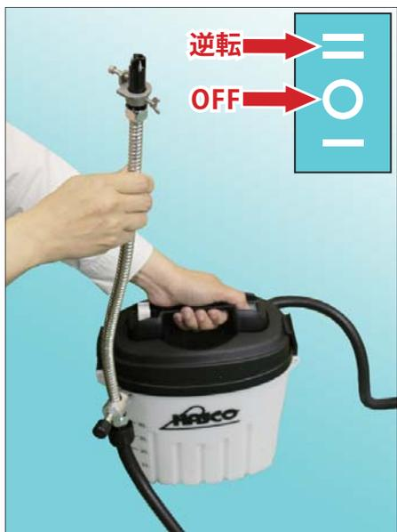
1. 作業終了後、リザーバーの液面レベルが MAX レベルを超えている場合、②のスイッチの逆転（=）を押して超えている分を吸引してください。また収納時、ホース内の残留フルードも吸引できます。
