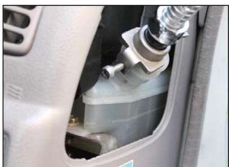
2. リザーバータンクからブレーキフルードが溢れない適度な液面レベルで供給が停止されることを必ず確認してください。
