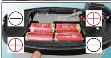
3. 新品のアルカリ単一電池×4ヶを用意していただき、内蓋の電極刻印に合わせてセットしてください。
