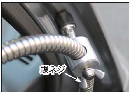
2. ⑩の蝶ネジを緩め、マグネット固定台座をフリーにします。作業車両の金属部分に傷をつけないようにマグネットを取り付けます。
