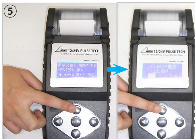
⑤本機の上矢印ボタンを押して、ディスプレイの画面がバッテリー電圧の表示になれば作業終了です。
