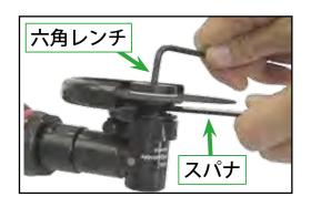
スパナで軸を固定してから六角レンチ (4mm) でセンターボルトを緩めます。
