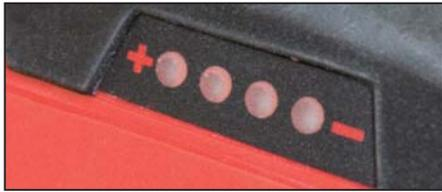
トリガーを軽く引いてバッテリー残量を確認してください。残量計は2、3秒間点灯します。点滅が1目盛りのみの場合、バッテリーはほとんど空の状態ですので充電を行ってください。
