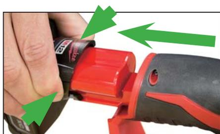
バッテリーを外すときは左右のリリースボタンを押してバッテリーパックを製品本体から引き抜いてください。
