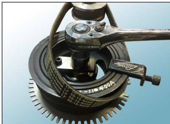
3. クランクプーリーを工具で時計回りにゆっくり静かに回してベルトを組み付けてください。
