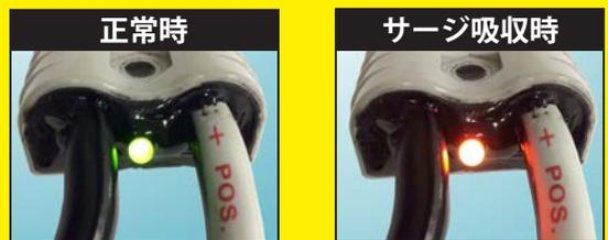
※サージを吸収した際は表示 LED が瞬間的に赤色に点灯します。
