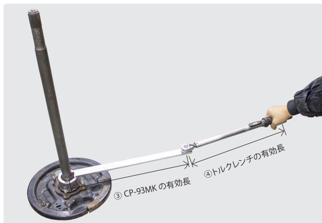
例) 有効長 <sup>②</sup>500mm のトルクレンチで締める場合
