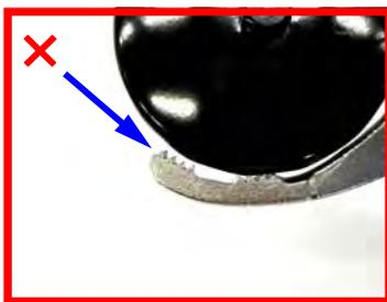
▲左記画像のように爪がオイルフィルターに食い付いていない状態で作業を行うと、フィルターがゆるまず、なめてしまうので注意してください。
