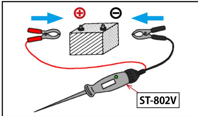
本製品の⊕、⊖クリップを車両搭載バッテリーの⊕、⊖端子にそれぞれ接続する。
