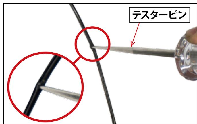
ショートが疑われるハーネスラインに本製品のテスターピンを被膜の上から刺し込み、測定する。
