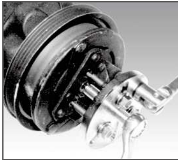
タップ無し3穴タイプ (ゼクセル) の抜き取り方
