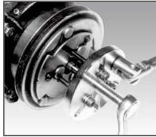
3本タップ式クラッチの抜き取り方 ボルトおよび座金は適当なサイズを別途ご用意ください。(適応 M8 まで)
