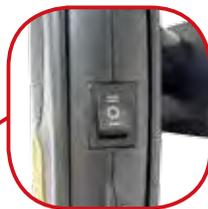
スイッチを「II」にセットし、放電器を作動させます。
