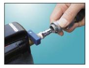
バルブを閉じた状態でエアー配管(圧力 0.5 ~ 0.7M pa) を接続します。
