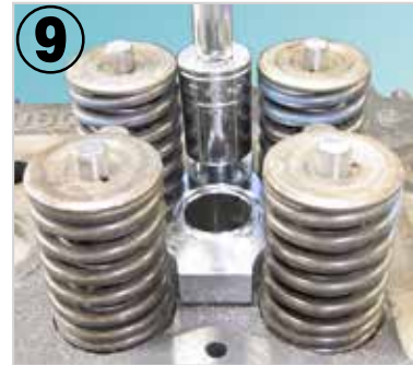
⑨シリンダーヘッドの既存のネジ穴に、 付属のボルト&座金でフランジを 固定します。
