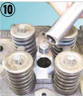
⑩ポンチガイドを入れます。 ※必ず、面取り側をノズルチューブ内に 入れてください、間違えると、 ノズルチューブ内部が変形します。
