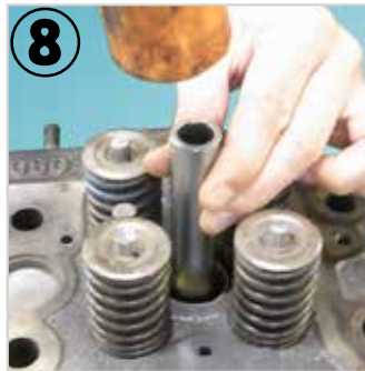
⑧新しいノズルチューブとOリングを 組み込みます。ポンチガイドを当て金 にして、プラスチックハンマーで 定位置まで打ち込みます。
