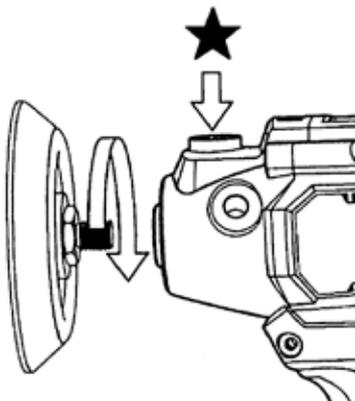
ネジ付きベースパッドの取り付け方法は左図の★ボタンを押してスピンドルをロックさせます。
