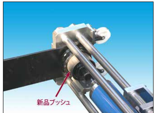
8, 新しいブッシュをセットし、抜き取り時と同様に、装着用アタッチメント(短い方、向きに注意)、当て金B、当て金Aの順にセットします。油圧ポンプを作用させて、基準の位置までブッシュを圧入します。
