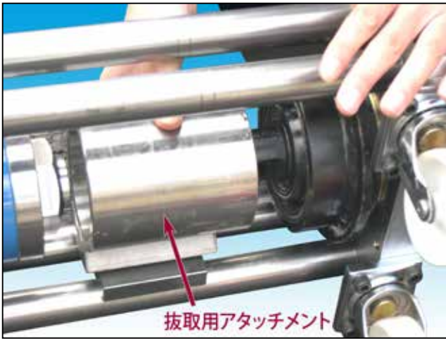
5, 抜取用アタッチメントB(長い方、向きに注意)、当て金B、当て金Aの順にセットします。
