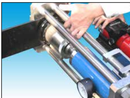
7, 新しいブッシュ装着時は、フロントプレート外側から、ガイドアタッチメントを径の細い方から入れ、ブッシュ装着部に嵌め込みます。この作業を怠ると、センターがずれた状態で無理が掛かり、ブッシュおよび本ツールが破損します。
