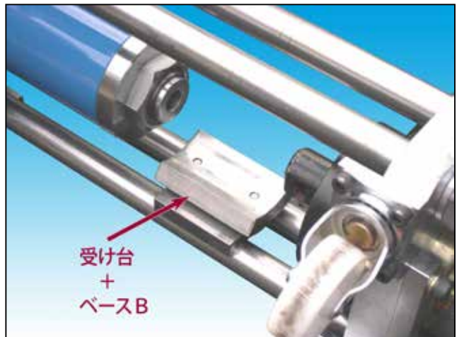
4, 横向きに使用の際は、ベースA底用を後方にずらし、ベースBサイド用をセットし、受け台をセットします。
