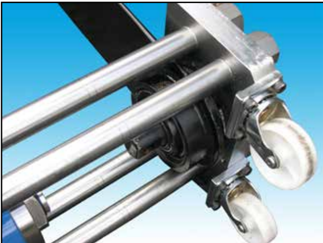
1, 本体枠内にブッシュ交換部を入れます。フォークリフトでつり上げるか、横に寝かせても使用可能です。
