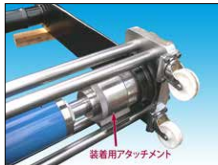
8, 新しいブッシュをセットし、抜き取り時と同様に、装着用アタッチメント(短い方、向きに注意)、当て金B、当て金Aの順にセットします。油圧ポンプを作用させて、基準の位置までブッシュを圧入します。
