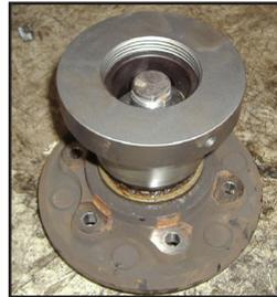
ヤゲン台上に、ステーを組み合わせて、写真のように安定した状態で、油圧プレスにセットしてください。(写真の当て金は、本セットには含まれません。)
