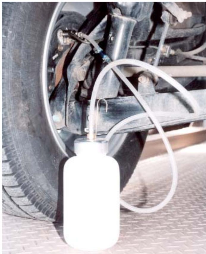
エアブリーダーに、ワンタッチロックのブリーダージョイント。ブレーキおよびクラッチエア抜き作業を、クリーンでスマートに完了できる手助け機器です。
