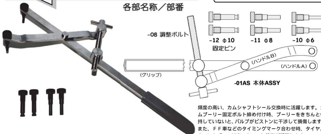
頻度の高い、カムシャフトシール交換時に活躍します。カムプーリー固定ボルト締め付け時、プーリーをきちんと保持していないと、バルブがピストンに干渉して損傷します。また、FF車などのタイミングマーク合わせ時、タイヤハウスにもぐっては出てといった苦労が解消します。
