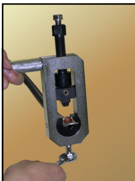
(4) 押し上げボルトを締め込んで、ターミナルを取り外します。
