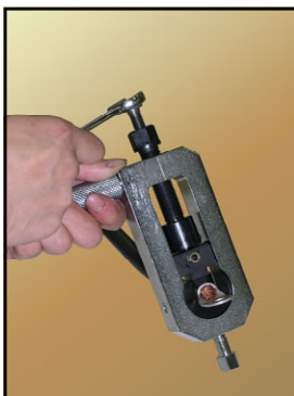
(3) センターボルトでカシメ不足の時、プレッシャーボルトを締め込みます。
