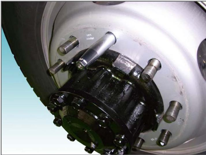
2カ所のナットを外し、本ガイドを取り付け後、ホイールの脱着を行います。元からセンターがずれていると、最後までねじ込めません。装着の際に増し締めしてください。
