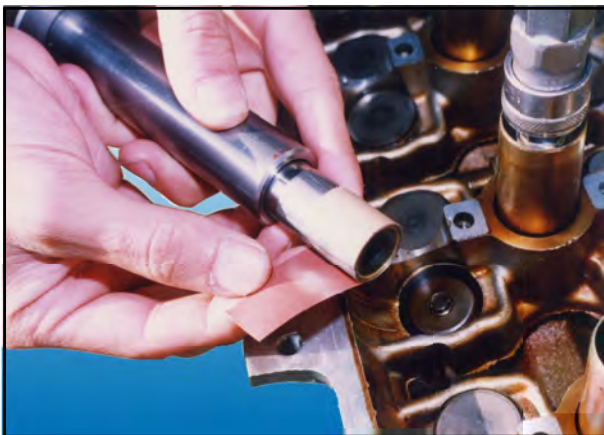
コッター離脱の原理 コッターがマグネットに吸着され、リテーナーと共に外れてきます。
