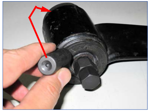
-03当て金のヘコミ側が表になる様に反対側からセットします。
