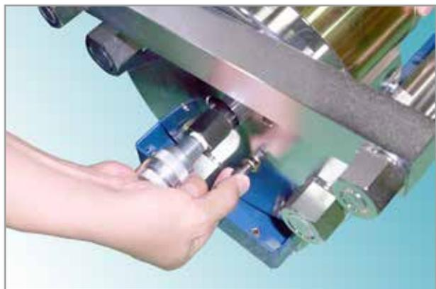
付属のキャップスクリュー、スプリングワッシャーで、4ヶ所のネジ位置を合わせて、しっかりと締め付けてください。
