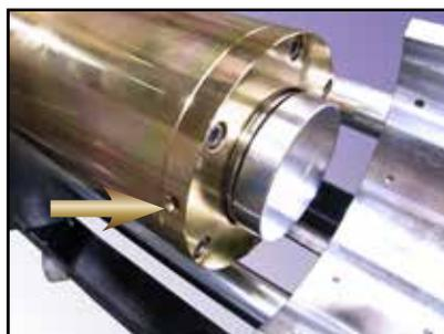
16, エアーガンで、ピストン戻し用穴に圧縮エアーを吹き込み、ピストンを戻します。ピストンは、最後まで完全に戻しておいてください。
