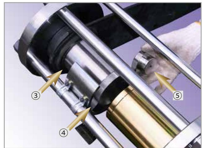
4, 抜取用アタッチメント③（長い方、向きに注意）、当て金A④（アタッチメント用）、当て金⑤（ピストン用の順にセットします。油圧ポンプを作動させて、ブッシュを抜き取ります。
