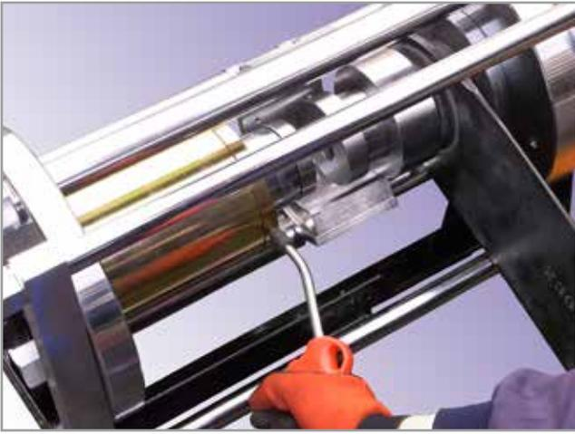
10, エアーガンで、ピストン戻し用穴に圧縮エアーを吹き込み、ピストンを戻します。この時ポンプ側は、開放状態にしておいてください。ガイド以外の各アタッチメントを外します。
