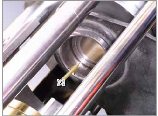
11, フロントプレート外側から、ガイドカラー②を径の細い方から入れ、ブッシュ装着部に嵌め込みます。この作業を急ると、センターがずれて無理が掛かり、ブッシュおよび本ツールが破損します。
