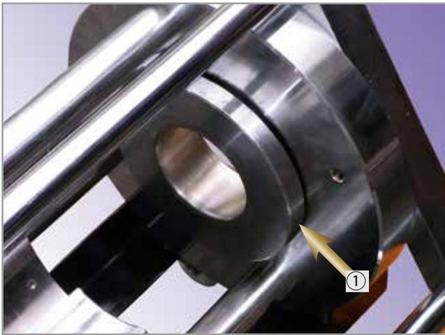
6, フロントプレート本体枠内側から、ガイド①をセットします。作業しやすい位置に本体枠を回転させて、交換するスタビリンカーブッシュ部を、当て木などでブッシュセンターが出るようセットしてください。
