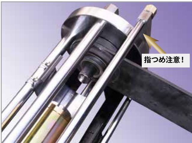
1, 本体枠内にブッシュ交換部を入れます。作業しやすい位置に本体枠を回転させます。
