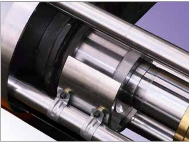
9, 定位置まで圧入が完了したら、6, の手順同様に、エアガンでピストンを戻します。
