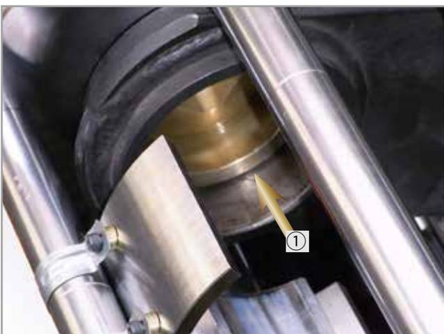
7, 新しいブッシュ装着時は、フロントプレート外側から、ガイドアタッチメント①を径の細い方から入れ、ブッシュ装着部に嵌め込みます。この作業を急ると、センターがずれた状態で無理が掛かり、ブッシュおよび本ツールが破損します。
