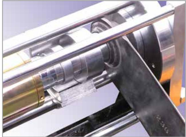
9, 油圧ポンプを作動させて、ブッシュを抜き取ります。※作動中は絶対に、ブッシュの抜け出し部を覗いたりしないでください。勢いよく飛び出すことがあります。※フロントプレート外側には、ウェスなどを敷いておいてください。(アタッチメント類の落下時キズ防止)
