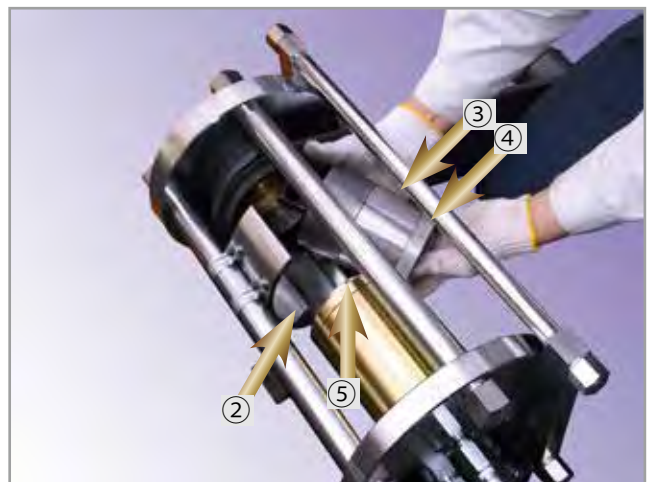
8, 新しいブッシュをセットし、抜き取り時と同様に受け金②をのせ、装着用アタッチメント③ (短い方、向きに注意)、当て金A④、当て金⑤の順にセットします。油圧ポンプを作動させて、基準の位置までブッシュを圧入します。 ※ 取り付け金具が動かないブッシュは、指定の向きに正確に合わせてから作業してください。
