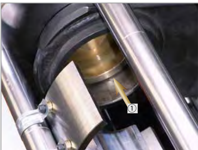
7, 新しいブッシュ装着時は、フロントプレート外側から、ガイドアタッチメント①を径の細い方から入れ、ブッシュ装着部に嵌め込みます。この作業を怠ると、センターがずれた状態で無理が掛かり、ブッシュおよび本ツールが破損します。
