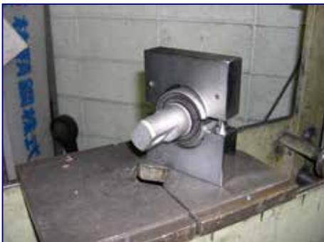
1. 新品ブッシュをブッシュコンプレッサーで挟み込みます。この時ブッシュはできるだけセンターに、割れの部分をツールの割れ部に合わせてください。(ブッシュの傷つき防止のため)
